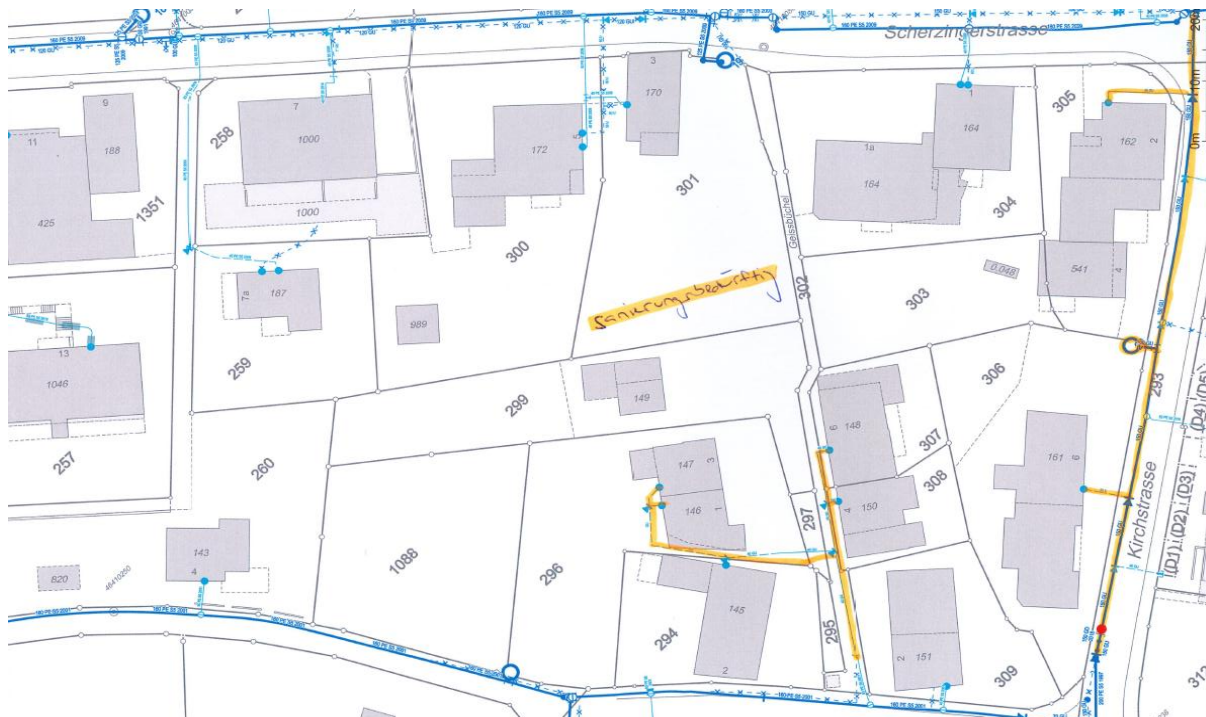
Abb. 13: Auszug Leitungskataster Wasserversorgung
